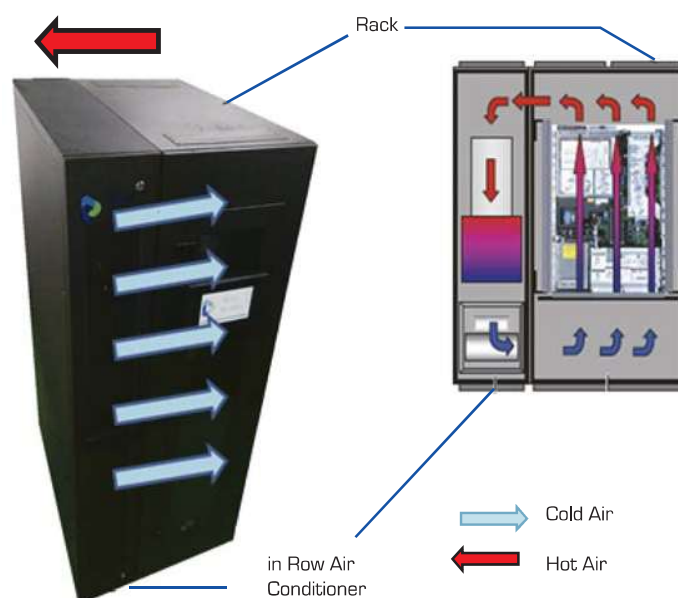
Ilustración 1. RACK con AIRE INROW acoplado, vista superior del rack para ver el flujo del aire, razón del espacio adicional utilizado.
